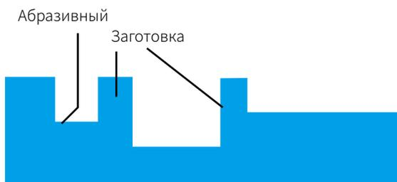
Магнитная игла магнитной полировальной машины может шлифовать внутреннюю часть отверстия, трещину, прямой угол, резьбу металлической заготовки и т.д., и скорость тонкого шлифования высока.
